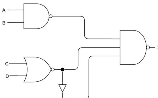
**Descrição da imagem do circuito lógico:** porta NAND com duas entradas, A e B, cuja saída é a primeira entrada da porta NAND com saída S; porta NOR com duas entradas, C e D, cuja saída bifurca para uma porta inversora; a saída bifurcada da porta NOR são as duas outras entradas da porta NAND com saída S.
